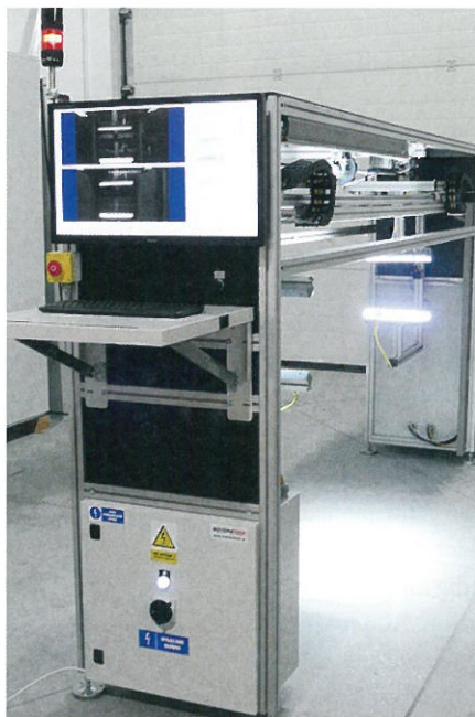
▲ Cognex-Technik inside: Inspektionsanlage zur hundertprozentigen Qualitätsprüfung montagefertiger Möbelteile von Automatech (Bilder: Automatech)
